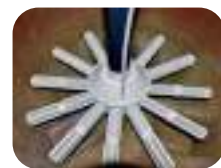
Σύστημα κολλέκτορα με diffuser Arm collectors
